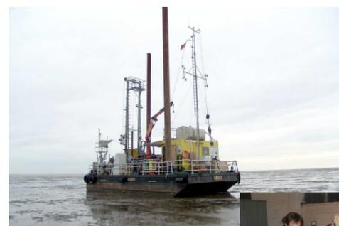
Mit einem Bohrponton wurden Bohrungen bis in eine Tiefe von 20 Metern durchgeführt.
